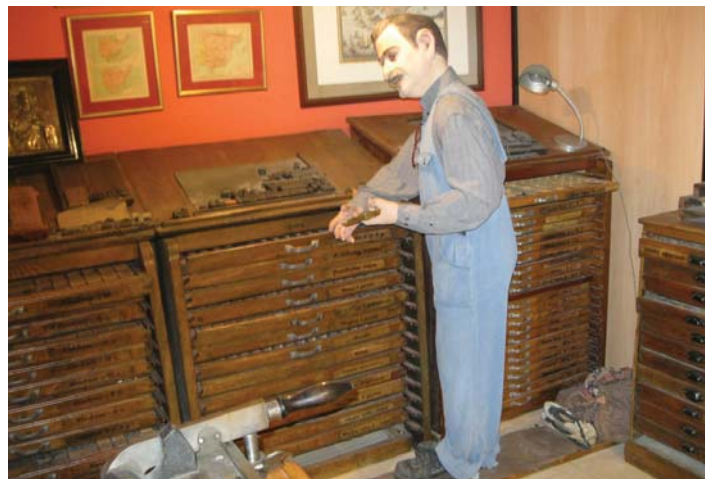
Hasta mediados del siglo XX, existían imprentas que usaban el sistema de tipos móviles, que el tipógrafo colocaba letra por letra.
